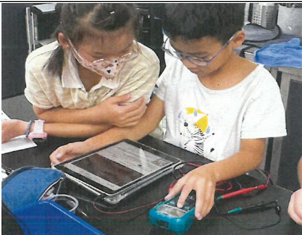
說明：利用三用電表測量平板耳機線的電壓
